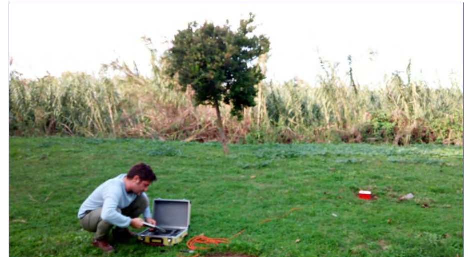
Foto 6- Esecuzione prova sismica (Tr1) mediante metodologia HVSr (Tr1)
