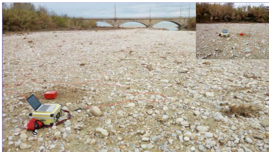
Foto 8 - Ubicazione ed esecuzione prova sismica (Tr3) mediante metodologia HVSr
