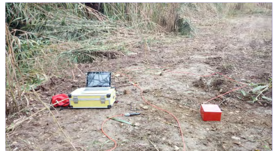
Foto 9 - Esecuzione prova sismica (Tr4) mediante metodologia HVSr
