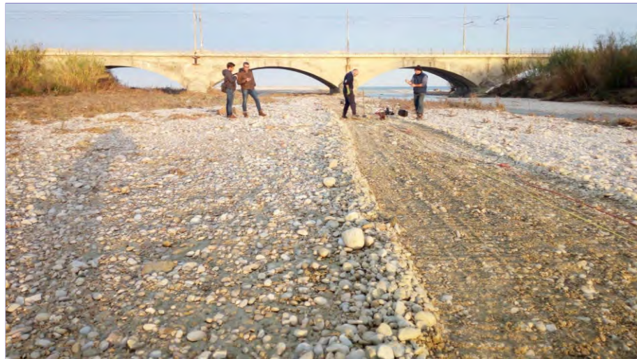
Foto 4 - Ubicazione ed esecuzione indagine sismica mediante metodologia MASW
